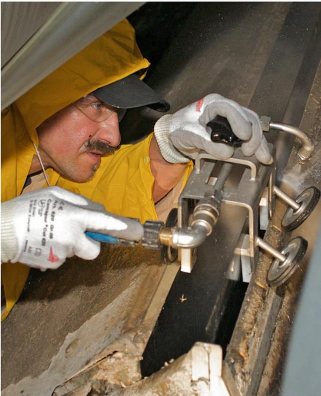
Die Stoffauflauflamelle spielt in der Maschine eine zentrale Rolle. Die messerscharfe Lamelle muss penibel gereinigt werden. Die Gefahr von Schnittverletzungen wird durch das prämierte Vorsatzgerät für Hochdruckreiniger minimiert.
