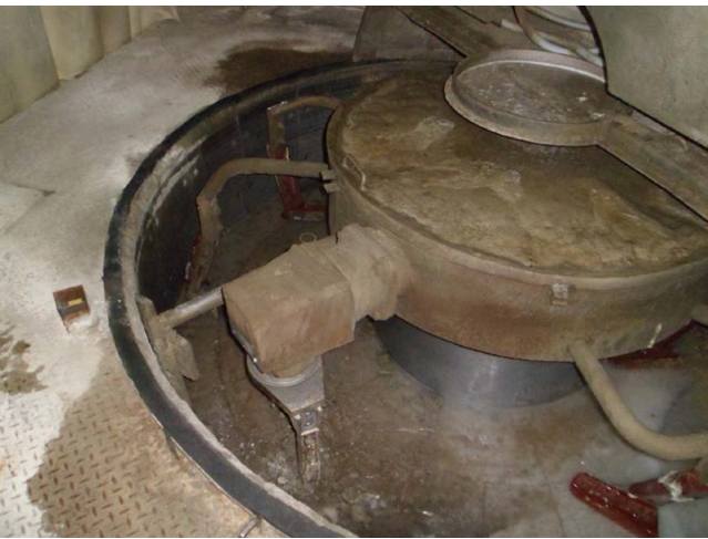
Geöffneter Mischer mit sichtbaren Mischarmen
