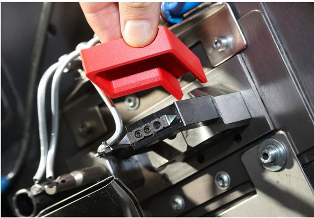
Die Kunststoffabdeckung lässt sich leicht über Messer und Halterung stecken und verhindert so, dass die Mitarbeitenden sich verletzen.
