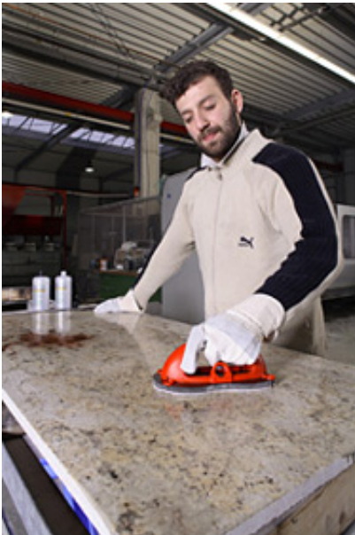
Auftrag des Oberflächenschutzes auf die Natursteinplatte
