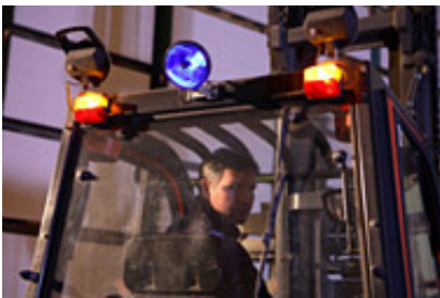
Der Blaulicht-Dachscheinwerfer am Dach des Gabelstaplers
