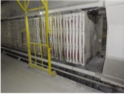
Abb. 3: Das neu entwickelte verfahrbare Schutzgestell neben der offenen Presse
