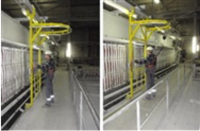
Abb. 7: Der gesamte Bereich ist gegen Zutritt durch Dritte gesperrt. Das Materialtor ist mit einem Schloss gesichert, die Zugänge zu den Pressen haben Kontaktschalter, die den Ablauf der Presse sofort unterbrechen.
