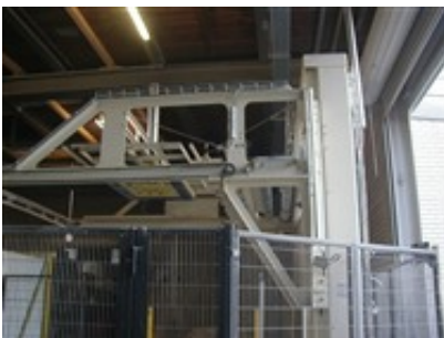
Zielposition Folienrolle: Hubrahmen in oberer Stellung des Palettenwicklers
