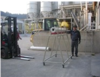
Folienrolle mittels Arretierung gesichert
