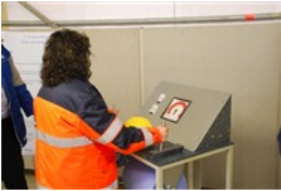
Modell zur Messung des eigenen ohmischen Widerstandes
