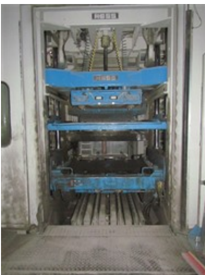
Steinfertiger - Halterung für Rinnenkernform ist ausgebaut
