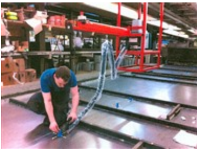
Mitlaufende Tankanlage im Einsatz
