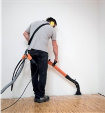
Der Motor des Schleifers wird getrennt vom Arbeitsgerät am Gürtel getragen.
