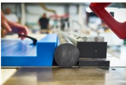
Zylindrische Bauteile können mit der Sägehilfe sicher bearbeitet werden.
