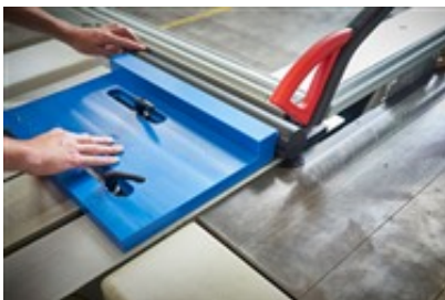
Sichere Führung des Werkstücks durch Arretierung mit zwei Klemmgriffen.
